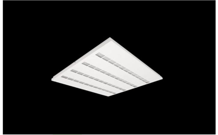
Innenbeleuchtung. Montage: Einbau in abgehängte Decken, direkt an der Decke oder mit Schlingen. Gehäuse aus Stahlblech. Arbeitstemperaturbereich: 5 ÷ 30° C. Stoßfestigkeitsgrad: IK04. Schutzklasse: I.
